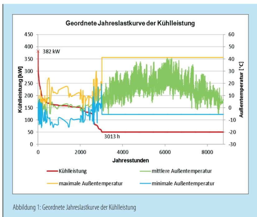
Abbildung 1: Geordnete Jahreslastkurve der Kühlleistung
